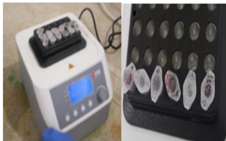
Colocar las muestras en el termobloque (65°C), por 15 min volteando las muestras cada 5 min
