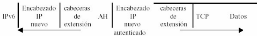
Figura 3.12: AH en Modo Túnel en IPv6
