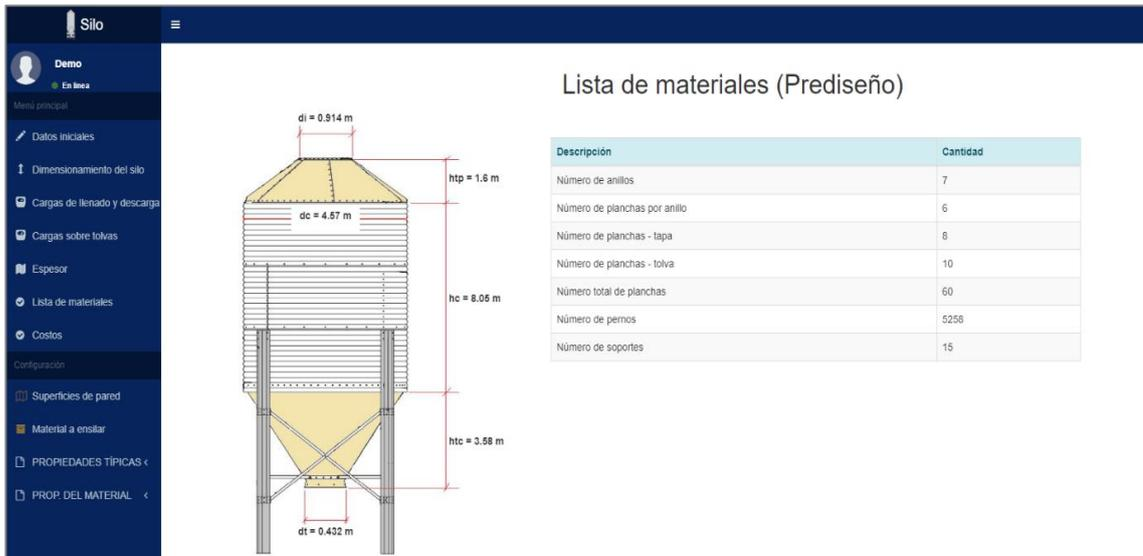
**Figura 10-5:** Resumen de material necesario para la construcción del silo.
