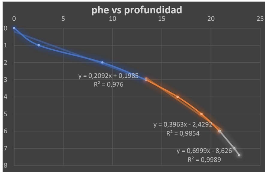
**Figura 14-3:** Perfil de presión horizontal linealizado
