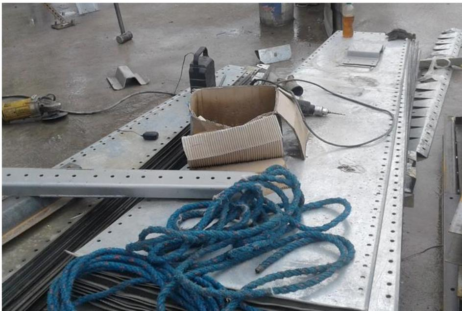
**Figura 2-A:** Planchas lisas de 3 mm para aramar el techo y la tolva
