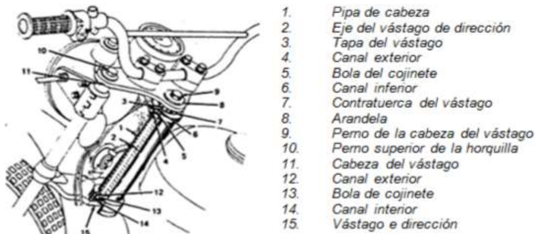
Ilustración 2-11: Mecanismo de dirección utilizada en una moto
