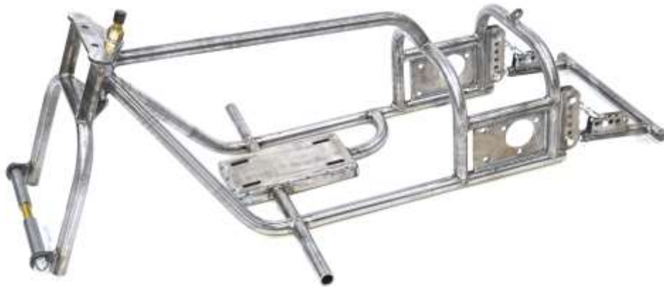
Ilustración 2-10: Chasis tubular de un mini T-Rex.
