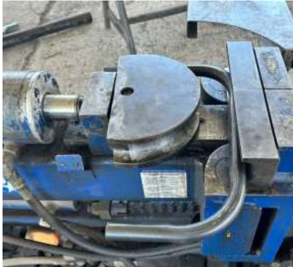
Ilustración 3-34: Doblaje manual de tubos.
