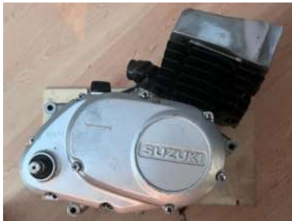
Ilustración 3-40: Motor AX100 Suzuki de 100cc
