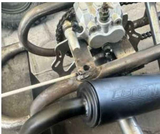
Ilustración 3-38: Soldadura de soportes.
