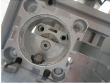
**Figura IV.51: Vástago del cilindro neumático BOSH 4 V 210 – 08 saliendo a través del aluminio cilíndrico**
