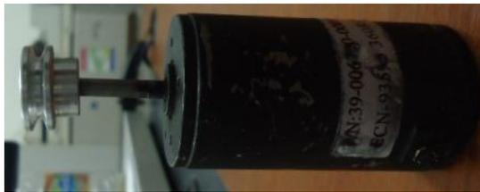
**Figura IV.45: motor de corriente continua**
