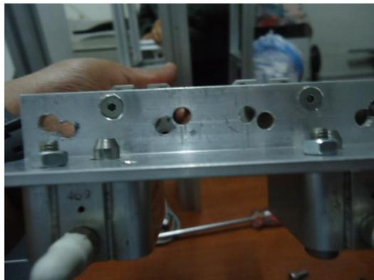
Figura IV.49: unión de los cilindros neumáticos BOSH 4 V 210 – 08 con los cilindros AIRTAC SDAS 20X50
