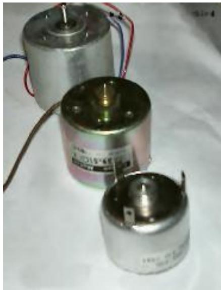
Figura II. 5 Motor de corriente continua
