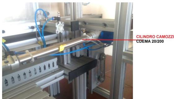
Figura II. 12: Cilindro CAMOZZI CDEMA 20/200
