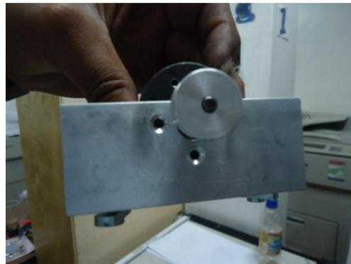
**Figura IV.46: ángulo de aluminio acoplado al motor**
