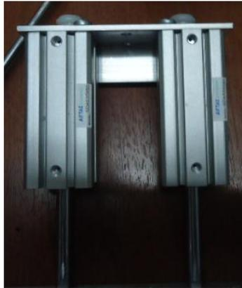
Figura IV.48: Unión de los Cilindros AIRTAC SDAS 20x50
