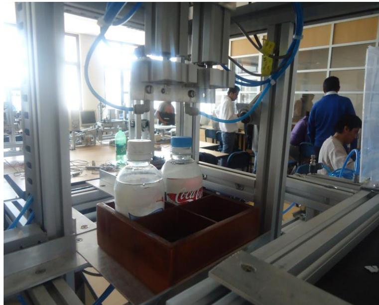
**Figura IV.79:** ubicación del sensor que se encuentra sobre la primera posición del palet del sistema de paletizado
