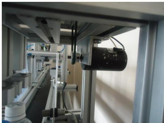
**Figura IV.47: motor de corriente continua acoplado a la estructura de aluminio e interactuando con el tornillo sin-fin**
