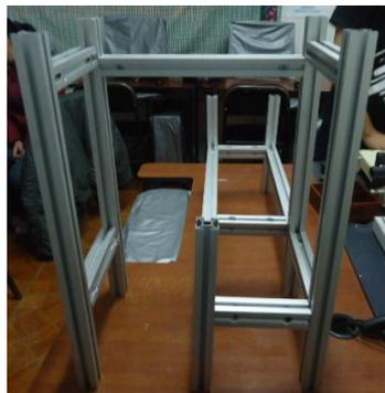
**Figura IV.37: Proceso de ensamblaje del sistema de paletizado**
