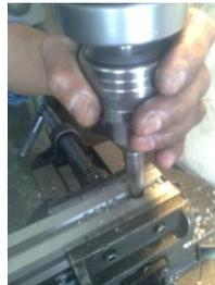
**Figura IV.34: Proceso de perforación de los extremos de los perfiles**
