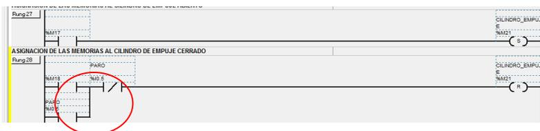
Figura IV.75: asignación incorrecta de la condición de parada a la salida
