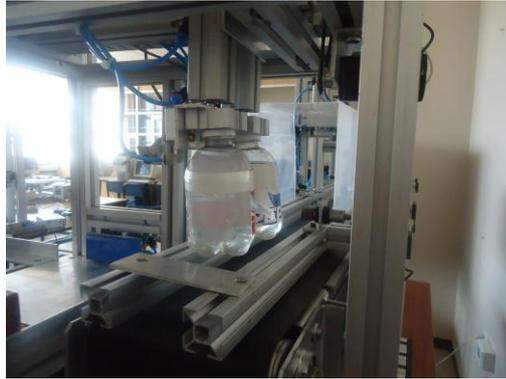
**Figura IV.77:** comprobación de la ubicación del sensor que esta sobre la banda del sistema de envasado de líquidos.
