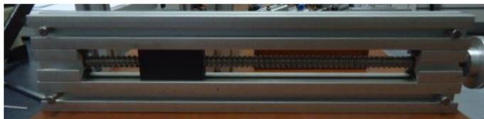
Figura IV.43: base de aluminio para el tornillo sin fin
