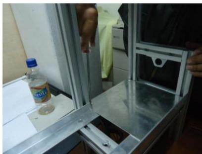
**Figura IV.38: Ensamblaje de los ángulos sobre la estructura de aluminio**
