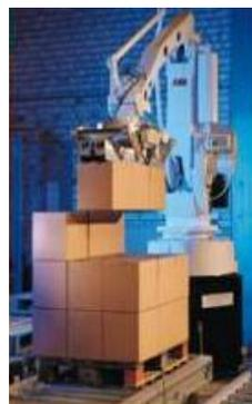
**Figura II. 6 Brazo de robot para paletizar**
