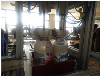
**Figura IV.783:** ubicación del sensor que se encuentra sobre la primera posición del palet del sistema de paletizado
