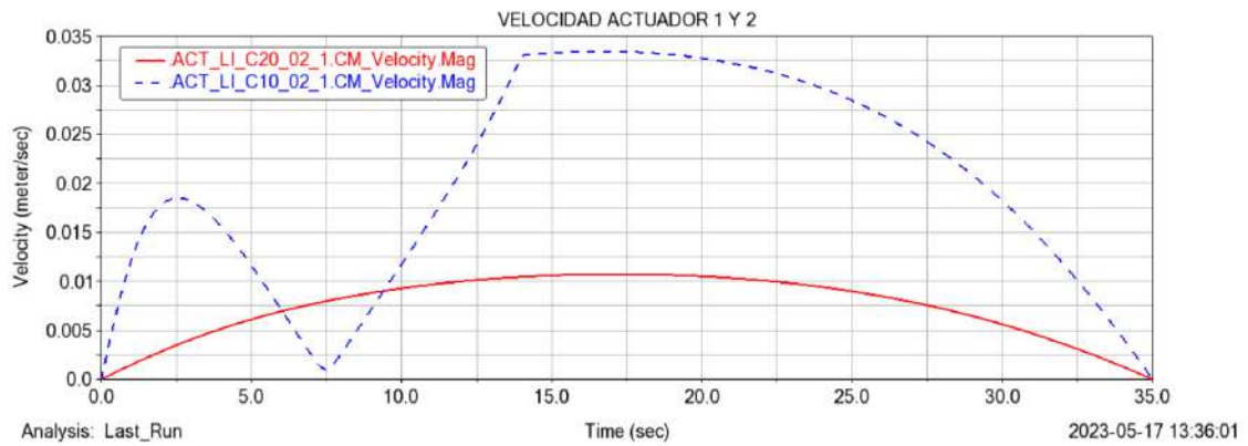
Ilustración 24-4: Gráfica de velocidad de los actuadores en bipedestación
