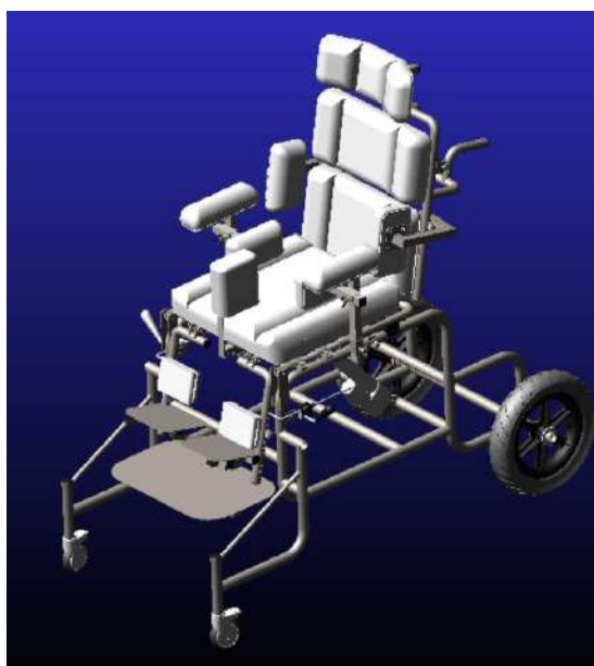
Ilustración 19-4: Silla bipedestadora de análisis en ADAMS
