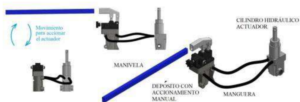
Ilustración 10-2: Componentes y funcionamiento del sistema hidráulico
