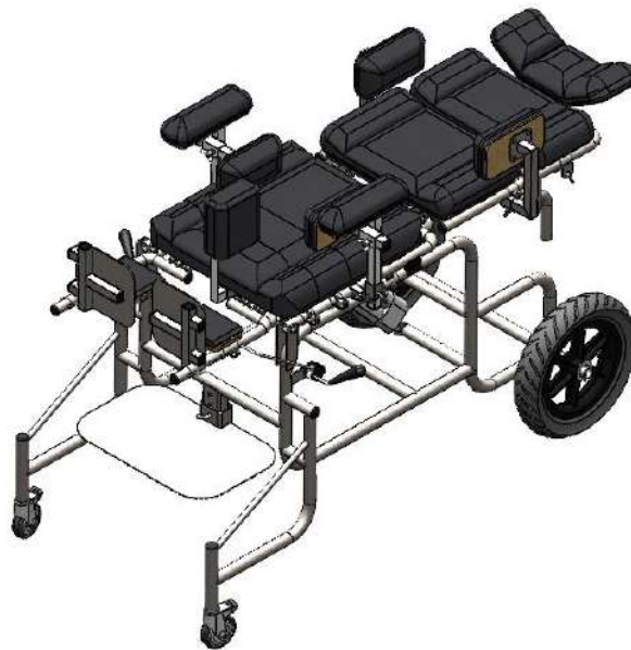
Ilustración 59-3: Silla de ruedas rediseñada en posición camilla
