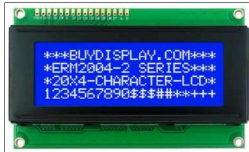
**Ilustración 25-3:** Pantalla LCD 20x4 I2C
