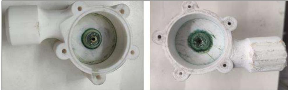
**Ilustración 4-4:** Fijación de bujes en la carcasa
