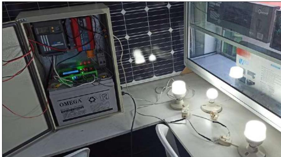
**Ilustración 27-4:** Prueba de funcionamiento de focos que consumen 55W
