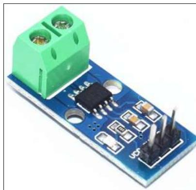
**Ilustración 22-3:** Sensor de corriente ACS712 – 30A
