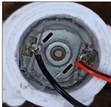
**Ilustración 9-4:** Soldadura de cables a las terminales del generador
