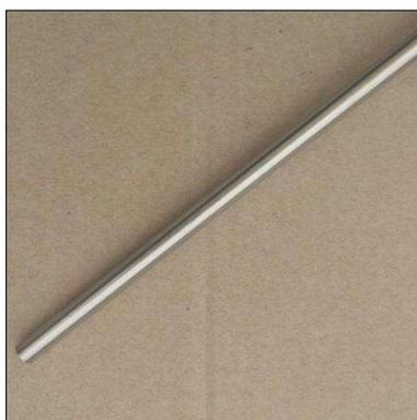
**Ilustración 3-4:** Barra de acero inoxidable AISI 304
