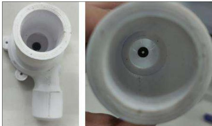
**Ilustración 5-4:** Fijación del retenedor en la carcasa superior de la microturbina
