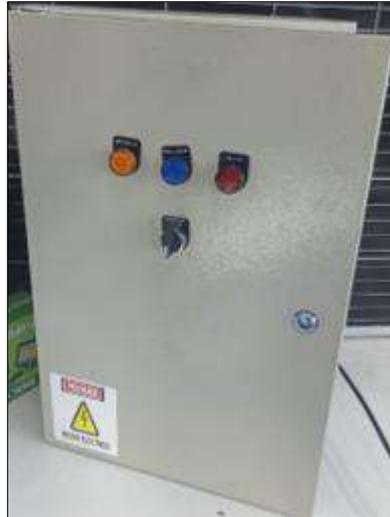
**Ilustración 21-4:** Tablero de control con los indicadores luminosos
