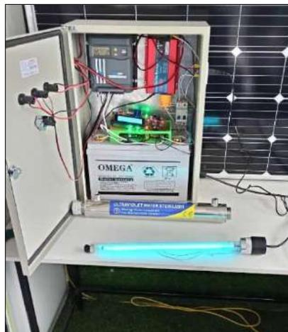
**Ilustración 26-4:** Prueba de funcionamiento de la lampara de desinfección de 55W
