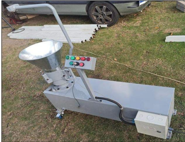
**Ilustración 64-3:** Ensamblaje máquina peletizadora
