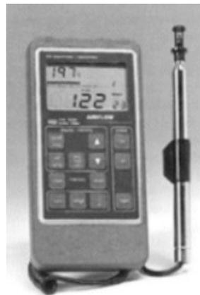
**Ilustración 5-2:** Termo-anemómetro de lectura digital.
