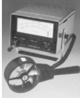
**Ilustración 4-2:** Anemómetro de lectura analógica.
