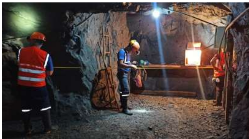
Ilustración 19-4: Levantamiento topográfico del área de descanso Nivel 5
