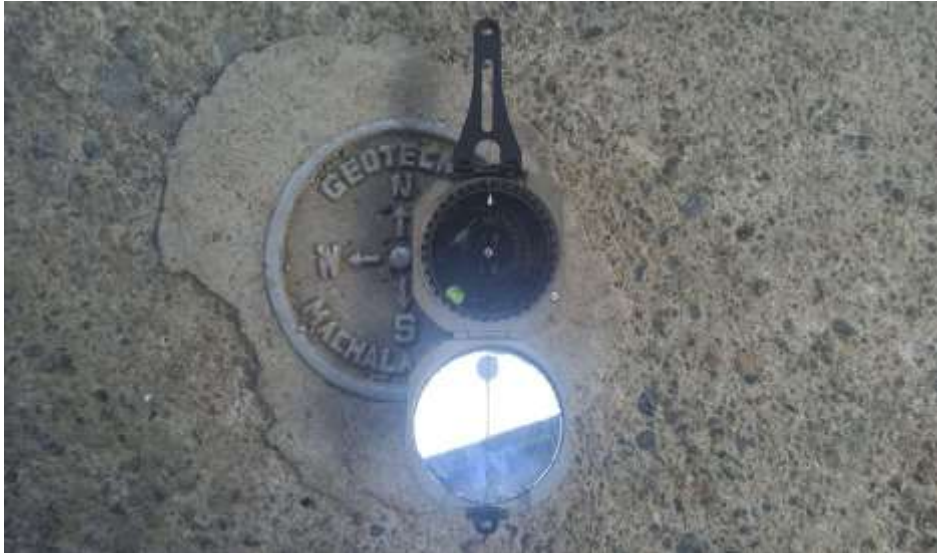
Ilustración 10-4: Hito geotécnico y brújula Brunton
