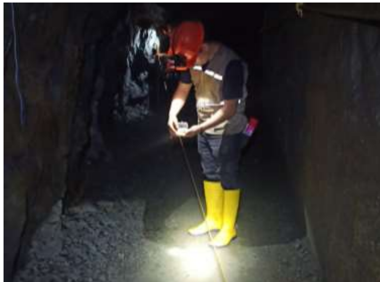
Ilustración 15-4: Medición de la galería de producción en el nivel 2
