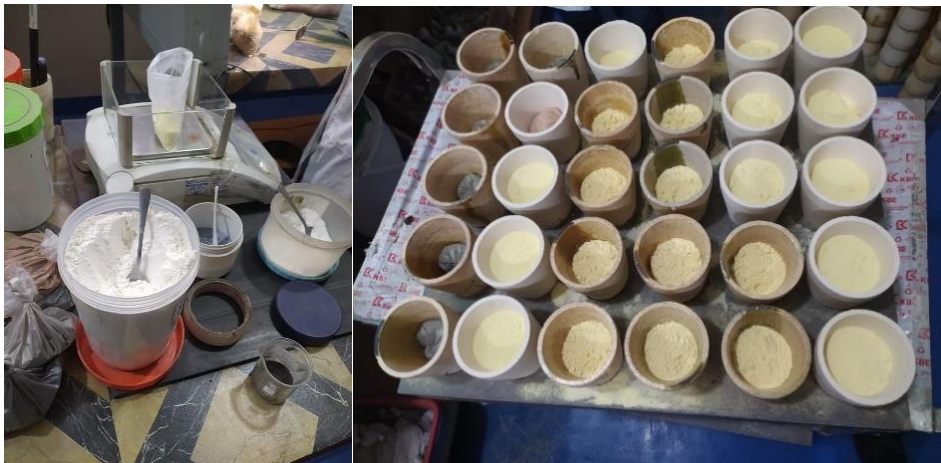
Ilustración 14-3: Pesado, homogenización y colocación de las muestras en los crisoles
