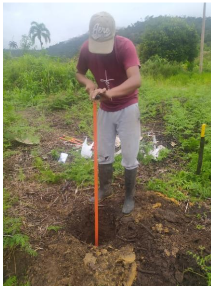
Sondeo manual de suelo
