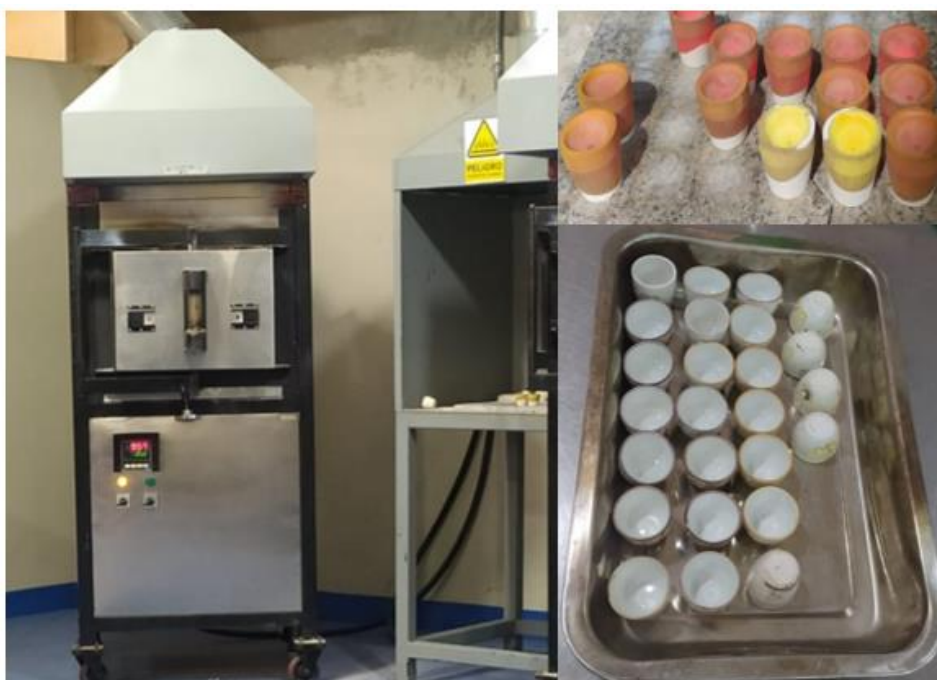
Ilustración 16-3: Proceso de copelación de las muestras
