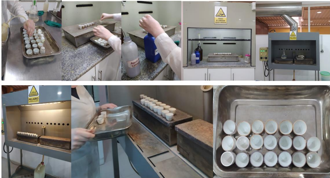
Ilustración 17-3: Proceso de disolución del doré
