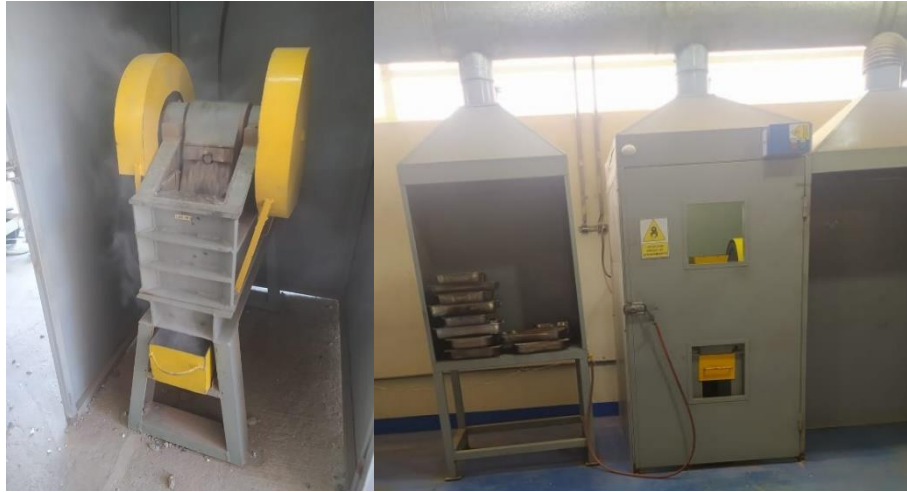
Ilustración 11-3: Trituración primaria y secundaria de las muestras
