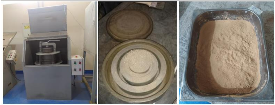
Ilustración 13-3: Proceso de pulverización de las muestras
