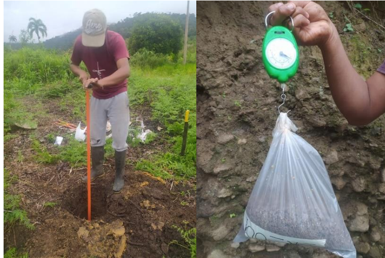
Ilustración 5-3: Obtención y pesado de la muestra
