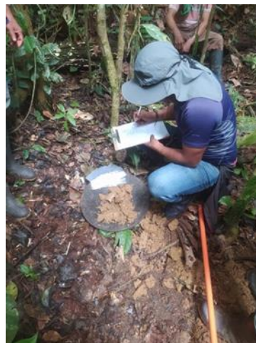
Ilustración 6-3: Codificado y caracterización de la muestra
