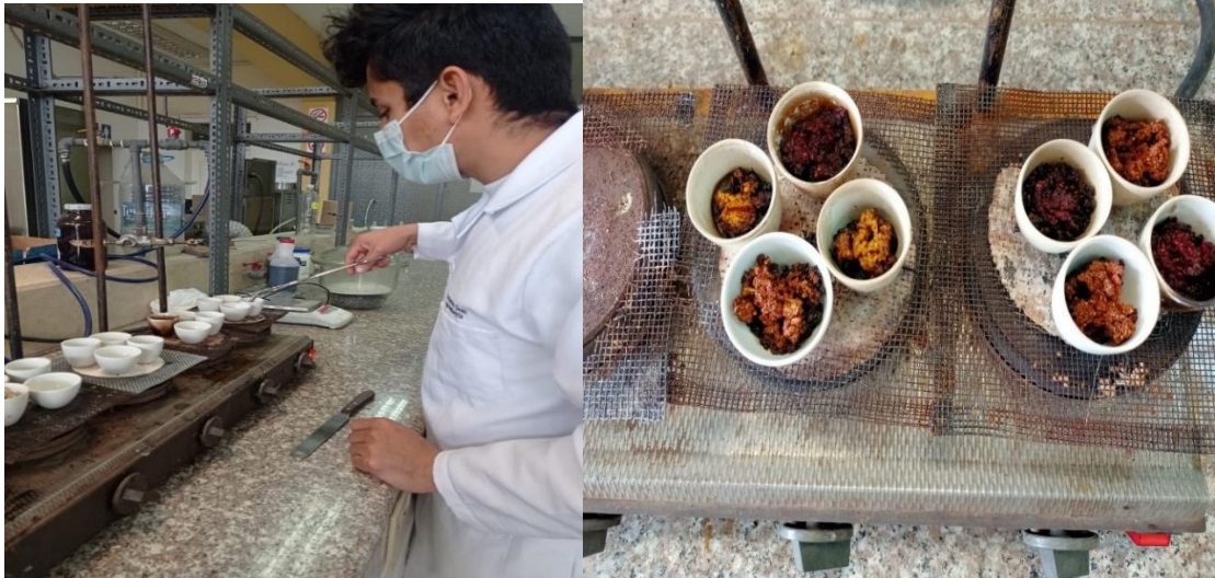
Proceso de calcinado en análisis de cenizas a las muestras
