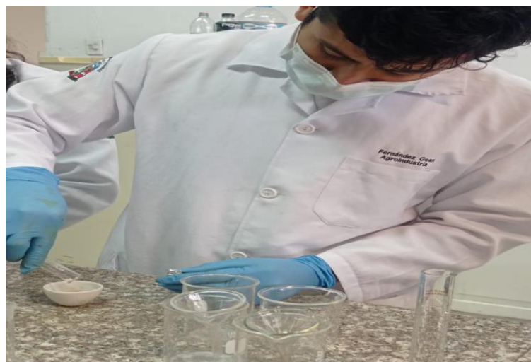
Proceso de preparación de estándares para la calibración del espectrofotómetro de absorción atómica
