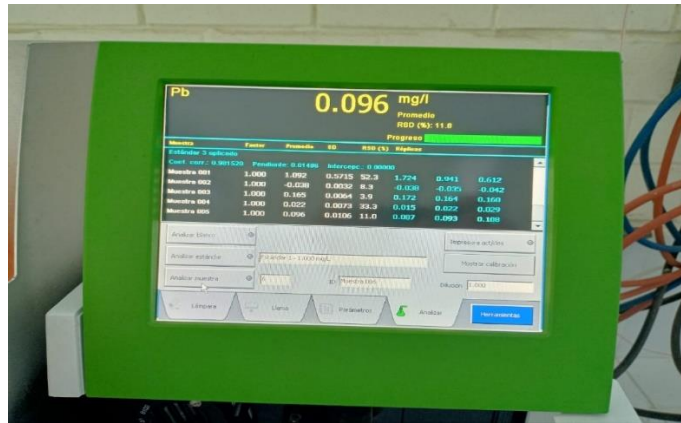
Lectura de plomo en las muestras por medio del espectrofotómetro de absorción atómica
