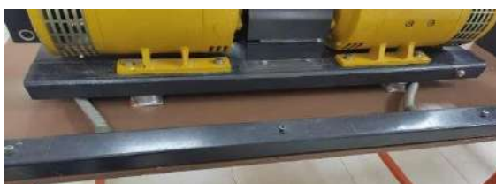
Ilustración 11-4: Anclaje del motor-generador.
