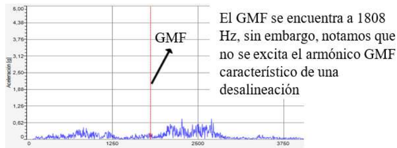
Ilustración 5-3: Prueba desalineación
