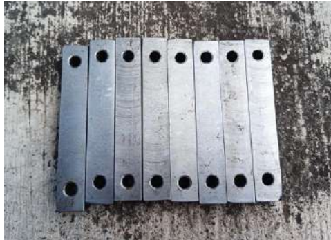
Ilustración 26-3: Acabado final de las bases del motor
