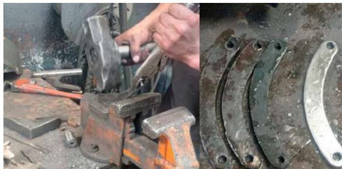
Ilustración 31-3: Mecanizado de los soportes circulares
