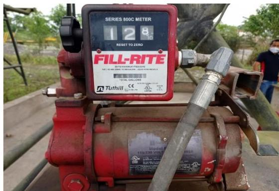
**Ilustración 2-2:** Bomba surtidora para Combustible diésel
