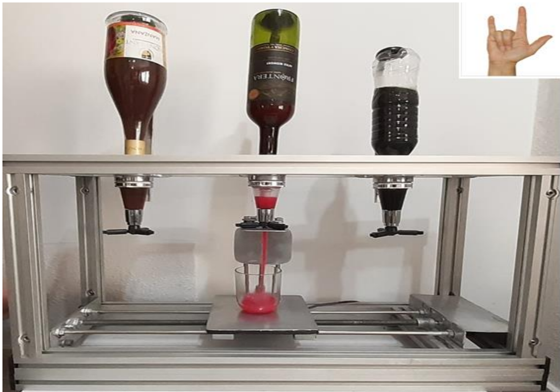
Figura 45-3: Proceso de dosificación en la estación 2
