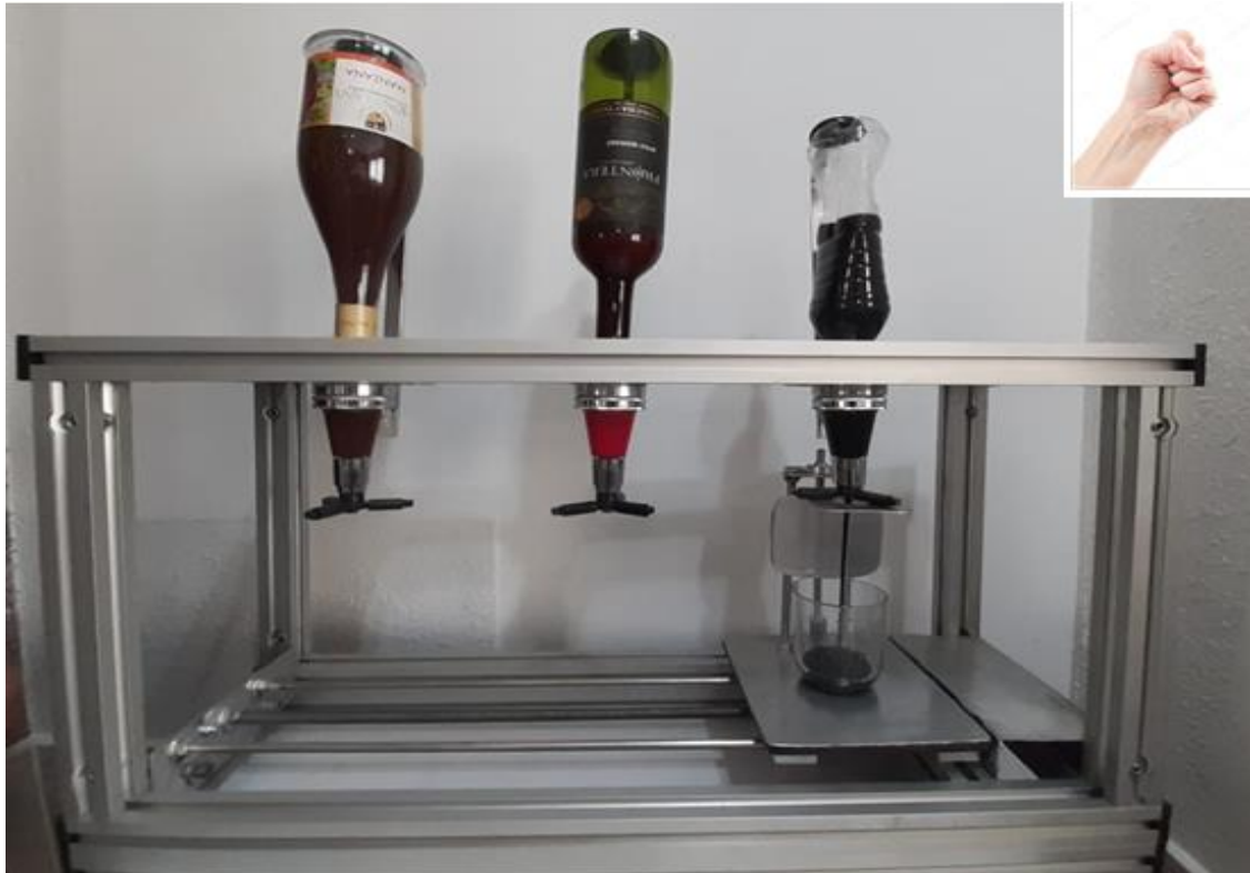
Figura 46-3: Proceso de dosificación en la estación 3
