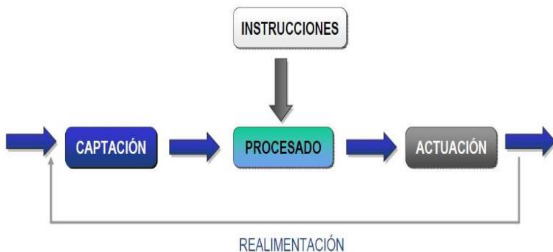
Figura 7-2. Ciclo de ejecución del algoritmo de visión artificial
