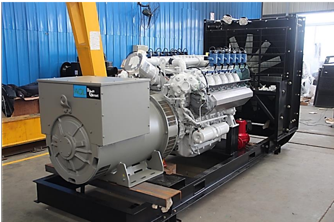
Ilustración 15 - 2: Generador a biogás.
