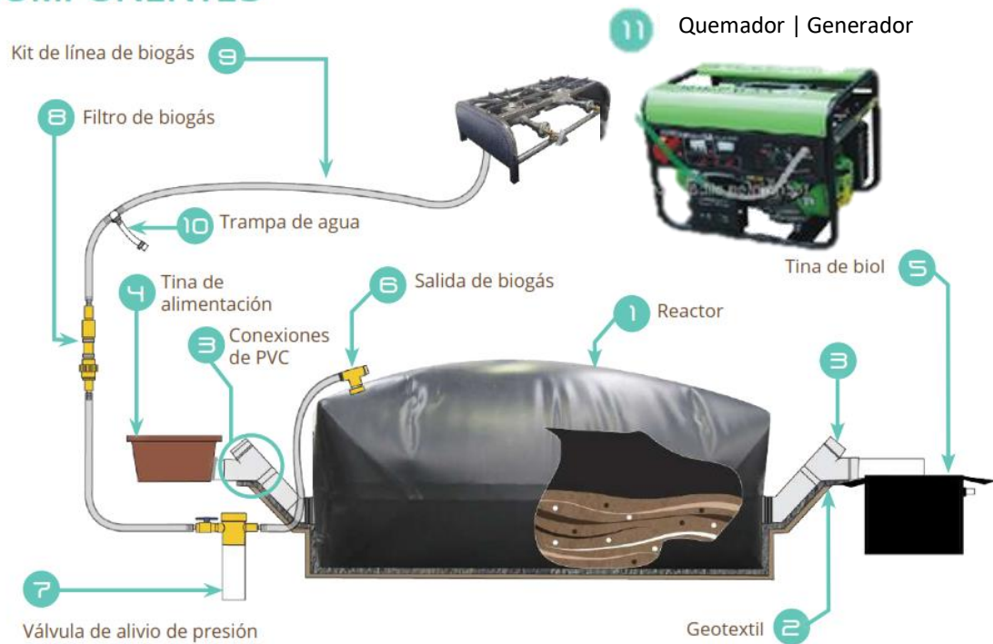
Ilustración 1 - 5: Detalle de partes del biodigestor.
