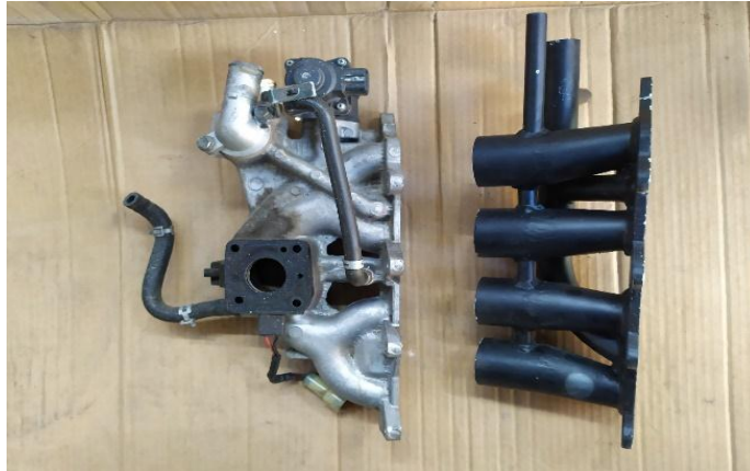
Figura 26-3: Múltiple de admisión para cuerpo de aceleración independiente
