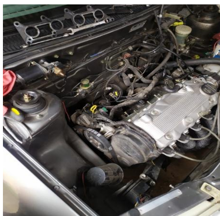
Figura 20-3: Extracción Múltiple de Admisión
