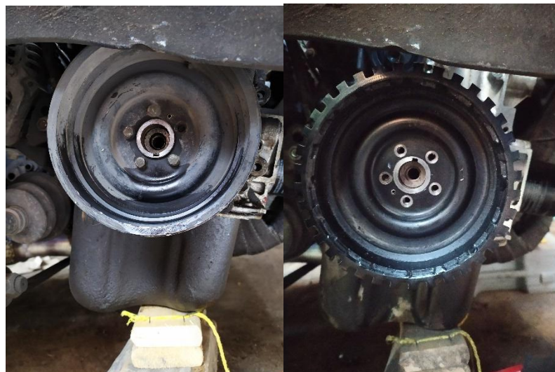
Figura 27-3: Rueda dentada instalada en la polea del cigüeñal
