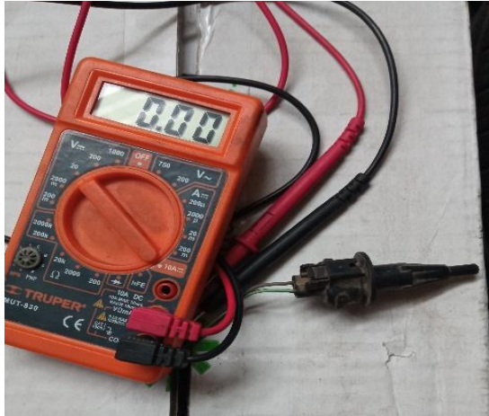
Figura 31-3: Medición de resistencia sensor de temperatura de aire
