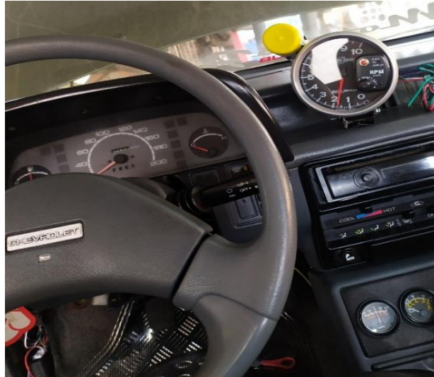
Figura 28-3: Instalación tacómetro en el tablero del vehículo
