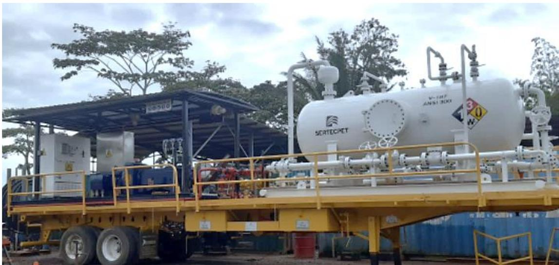
**Figura 5-2:** Unidad móvil de prueba eléctrica (MTUe)
