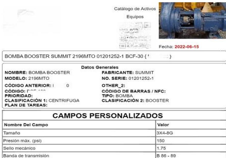
**Figura 3-4:** Datos técnicos del componente (bomba booster)
