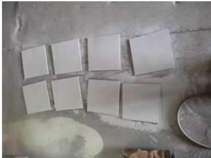
**Figura 7-2:** Placas luego de aplicar sandblasting
