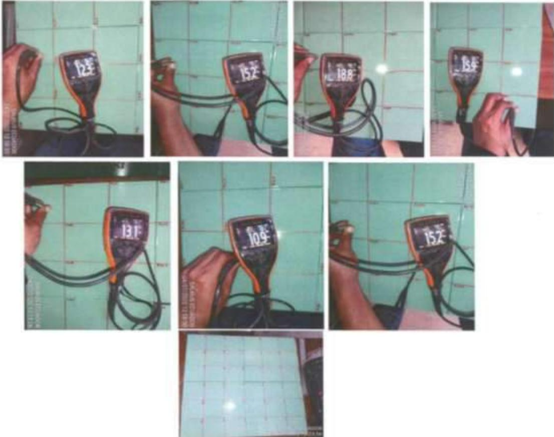
OBSERVACIONES: 1.- Registro fotográfico del proceso - levantamiento de espesores de pintura en seco y ensayos de adherencia método "A" según la norma. La clasificación de resultados de adhesión son: 5 "A" y 4 "B"
