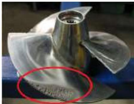
**Figura 2-1:** Corrosión por cavitación
