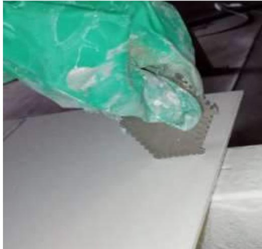
**Figura 17-2:** Medición de espesores de capa húmeda
