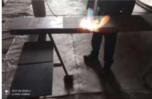
**Figura 14-2:** Calentamiento de las placas de acero previo al pintado
