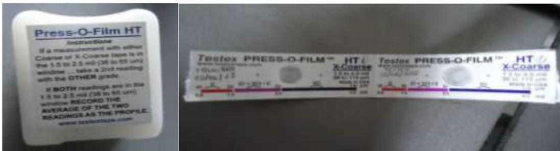
**Figura 9-2:** Cinta Testex para pruebas PRESS-O-FILM
