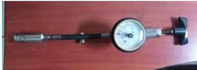
**Figura 24-2:** Medidor de adherencia hidráulico
