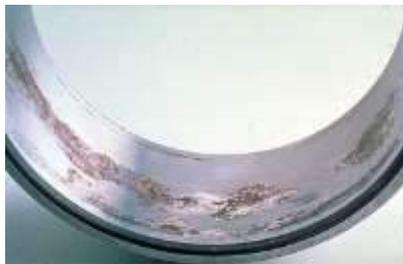
**Figura 1-1:** Corrosión por fricción
