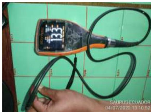
**Figura 21-2:** Medidor de espesor Magnético
