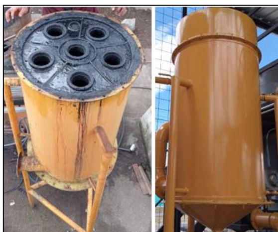
Figura 10-4: Habilitación de la cámara de filtrado - Mangas
