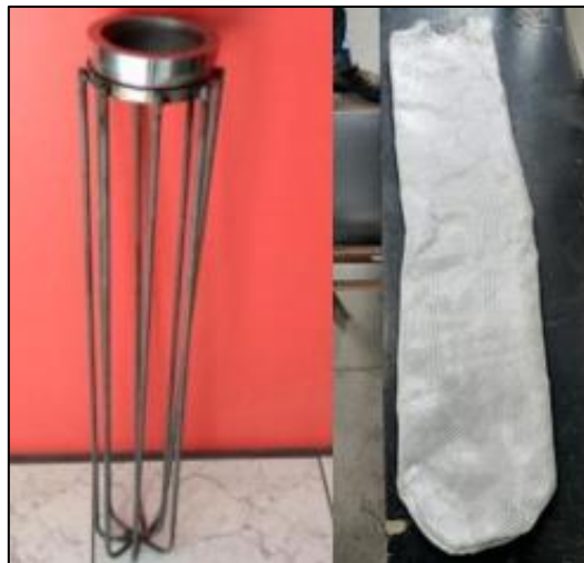
Figura 8-4: Recorte y Cosido de la tela de fibra de vidrio
