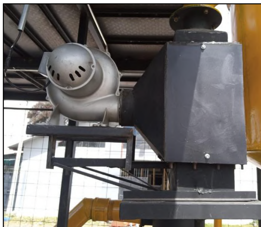
Figura 17-4: Enfriamiento y condensado del syngas
