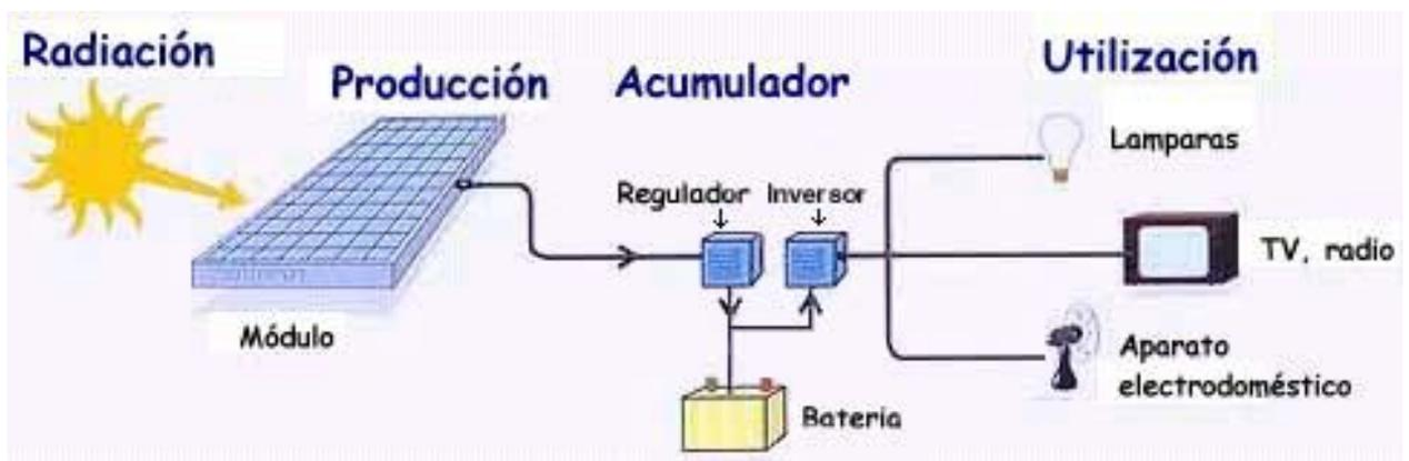
**Figura 3.18** Una instalación solar fotovoltaica con inversor, utilización a 230Vca [30]
