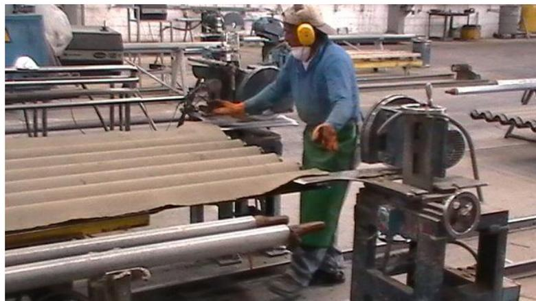
Figura 17. Transporte y corte longitudinal
