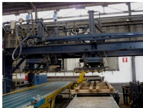
Figura 8. Proceso de desmoldeo y desbarbado
