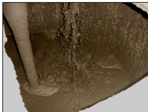
Figura 6. Pasta final de fibrocemento
