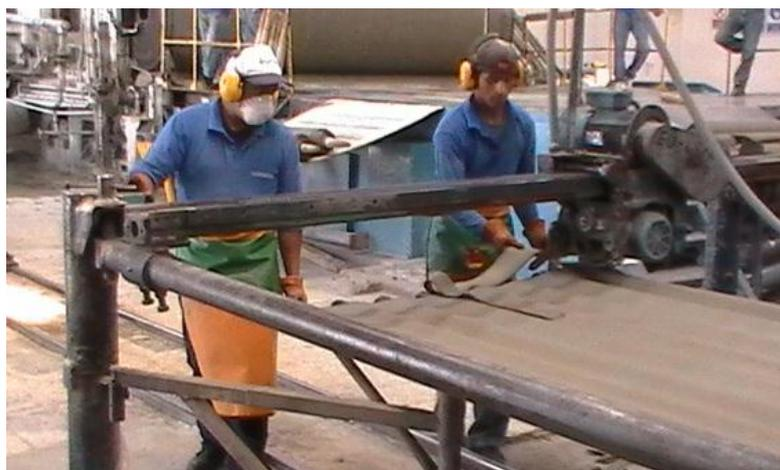
Figura 15. Transporte y corte transversal
