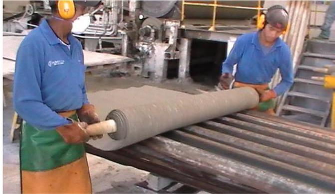
Figura 14. Desenrollamiento de la placa sobre el molde
