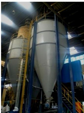
Figura 4. Silos para almacenar cemento
