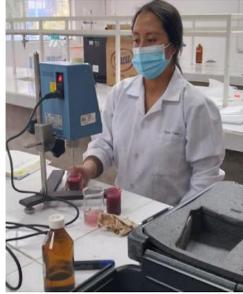
**Figura 24:** Determinación de viscosidad.
