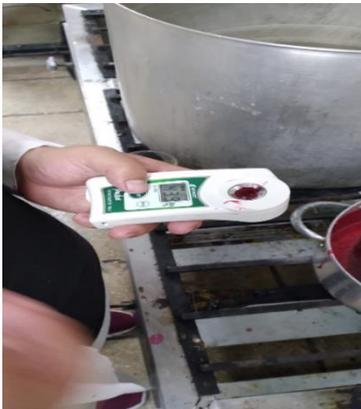
**Figura 20:** Medición de °Brix.
