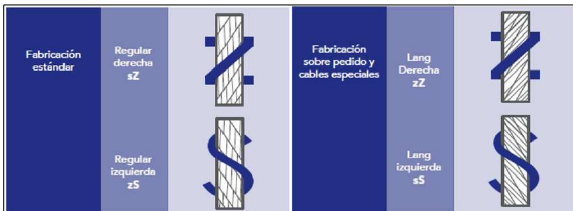
Ilustración 16-2: Tipos de torsión en un cable
