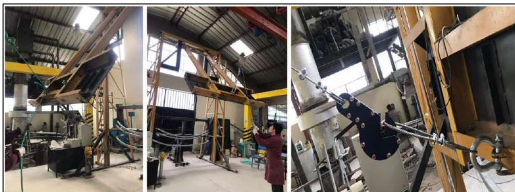
Ilustración 29-4: Accionamiento mediante cuerda y gancho de liberación
