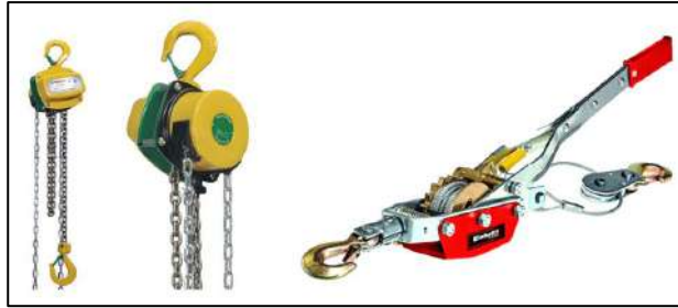
Ilustración 10-2: Sistemas de elevación mecánicos
