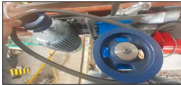
Ilustración 54-3: Colocación de las bandas de transmisión en las poleas
