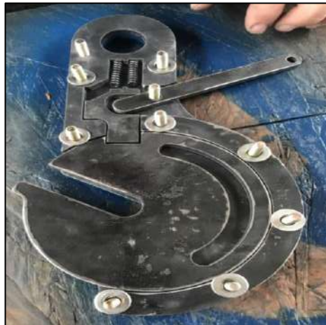
Ilustración 63-3: Ensamble del gancho
