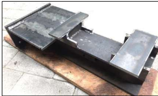
Ilustración 46-3: Conformación del bastidor
