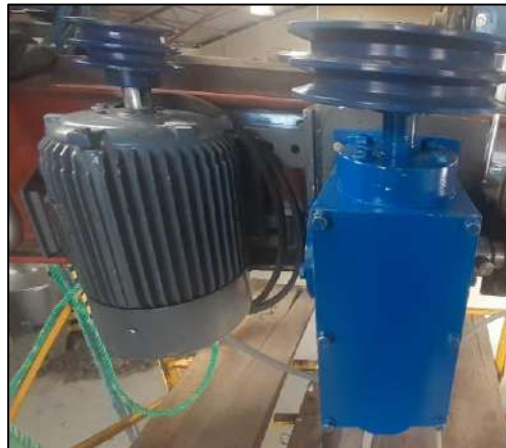
Ilustración 52-3: Montaje caja reductora
