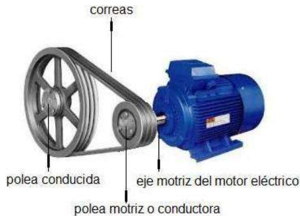
Ilustración 27-2: Transmisión de potencia por correa.
