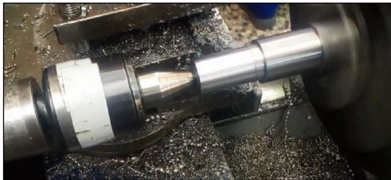
Ilustración 43-3: Cilindrado del eje
