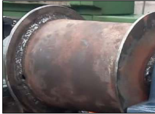
Ilustración 42-3: Conformado del tambor
