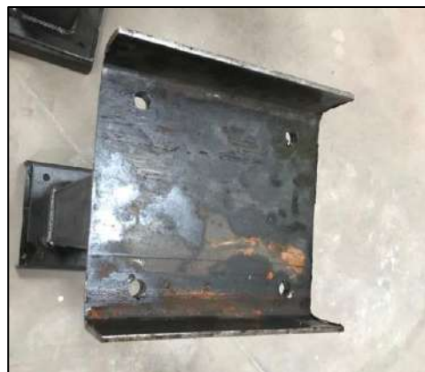
Ilustración 21-4: Perforación del perfil C
