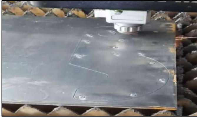
Ilustración 62-3: Corte laser de la geometría del gancho
