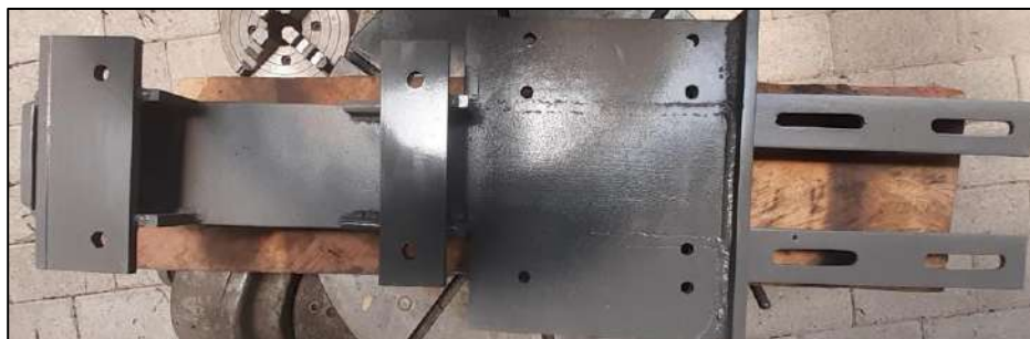
Ilustración 47-3: Pintura del bastidor
