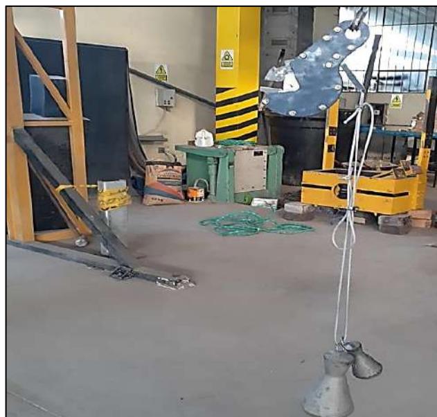
Ilustración 28-4: Fuerza de accionamiento del gancho
