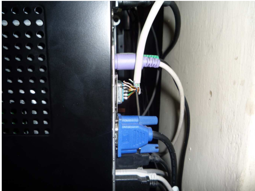
Figura 99: Conexión entre el BS2 y la PC a través del cable preparado
