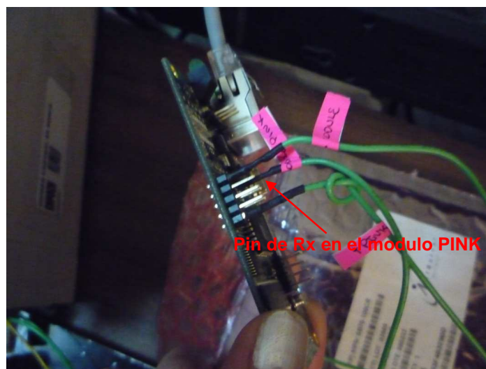
Figura 74: Pin en el modulo que recibe la información
