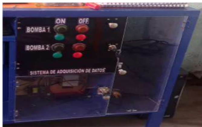
Ilustración 25-3: Remplazo de cerraduras y topes de presión
