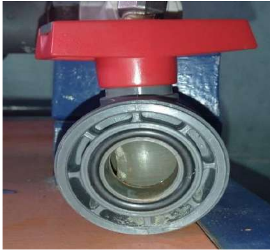
Ilustración 13-3: Válvula tipo de dos universal
