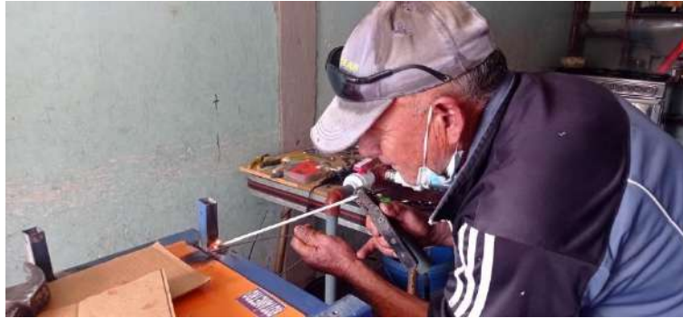
Ilustración 24-3: Soldado de los soportes de tuberías
