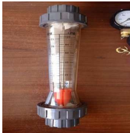
Ilustración 23-3: Rotámetro de 100 LPM
