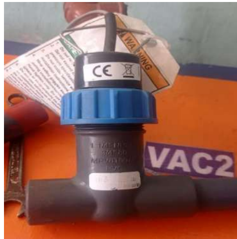
Ilustración 17-3: Sensor de flujo GF 2536
