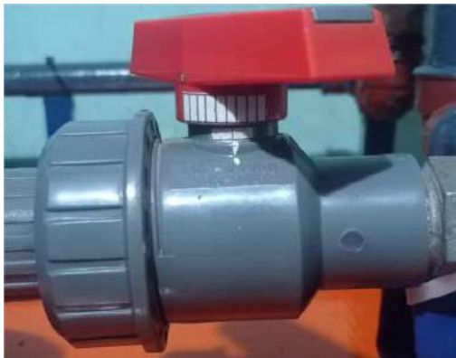
Ilustración 28-3: Válvula número seis con división del ángulo de 0^\circ - 90^\circ
