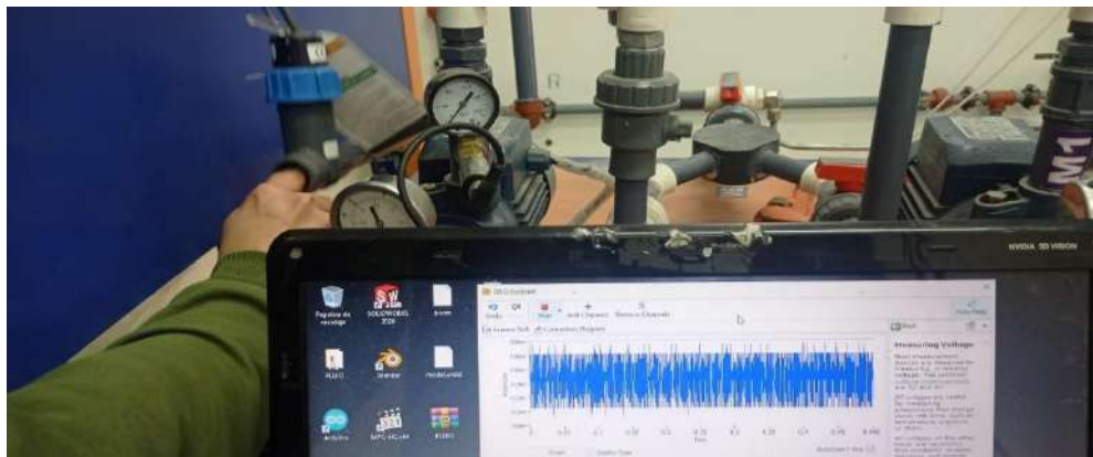
Ilustración 19-3: Comprobación del funcionamiento de los sensores y transductores
