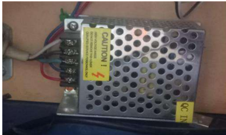
Ilustración 16-3: Fuente de alimentación SC-POWER-12V25W
