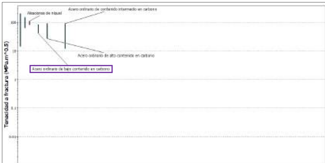
Ilustración 10-3: Representación de la tenacidad a la fractura
