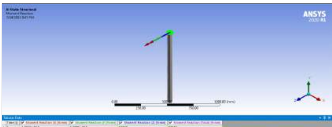
Ilustración 17-4: Valores de los momentos en el punto de apoyo empotrado
