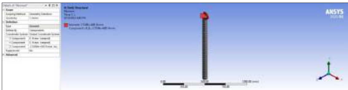
Ilustración 111-3: Aplicación de momento para las columnas principales
