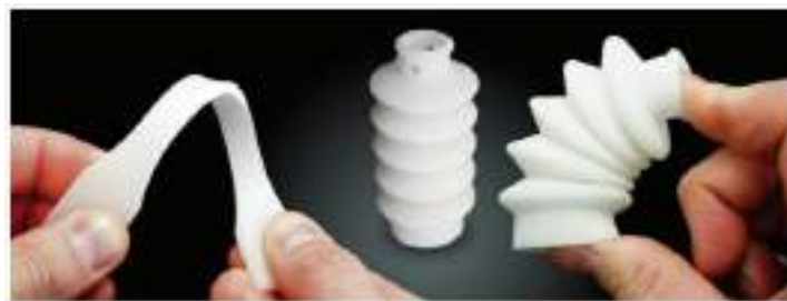
Ilustración 5-2: Piezas impresas en 3D utilizando resina polimérica
