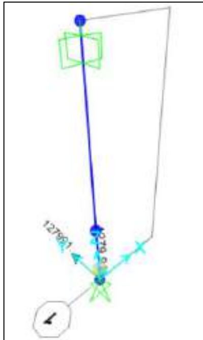
Ilustración 30-3: Carga aplicada sobre el elemento móvil
