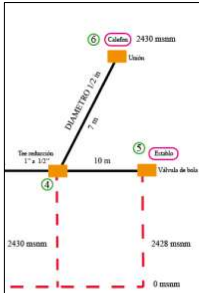
Ilustración 11-3: Esquema del tramo 3, puntos 4-6
