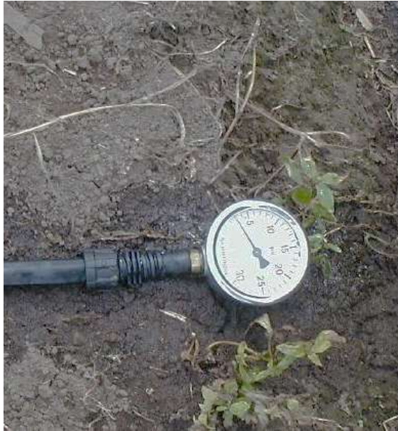
Ilustración 66-3: Medición experimental de la presión
