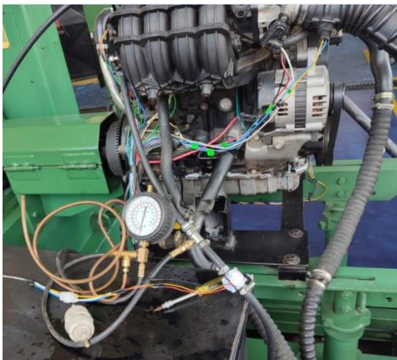
**Figura 2-3:** Instalación de medidor de presión de combustible
