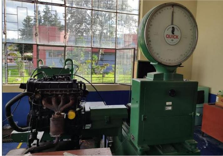
**Figura 3-2:** Banco dinamométrico
