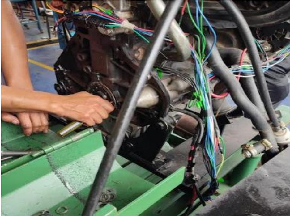
**Figura 2-2:** Motor de prueba. Aveo 1,6 L en mantenimiento
