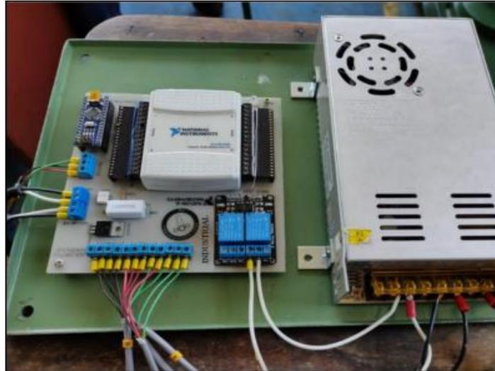
**Figura 19-2:** Tarjeta de adquisición de datos NI USB 6009 del dinamómetro
