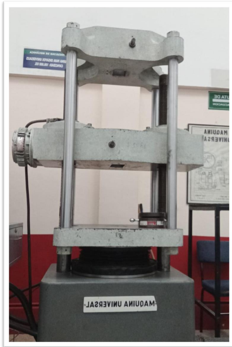
Ilustración 13-2: Máquina Universal para el Ensayo de Compresión Uniaxial
