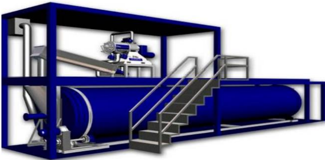
Figura 7-1. Esquema de un secador tipo tambor
