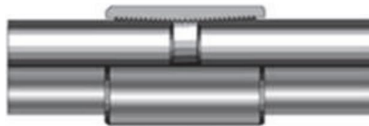
Figura 3-2. Conexión sin extremos recalcado NU.
