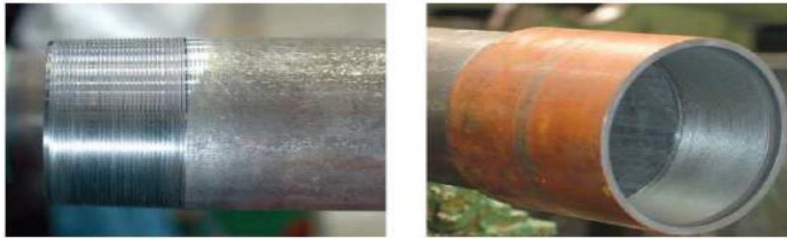
Figura 2-2. Pin y caja roscadas de una tubería de producción.
