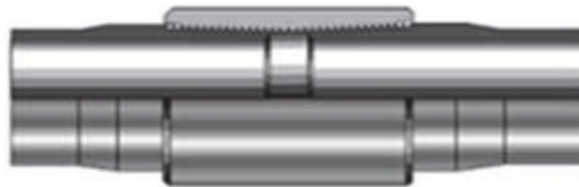
Figura 4-2. Conexión con extremo recalcado EU
