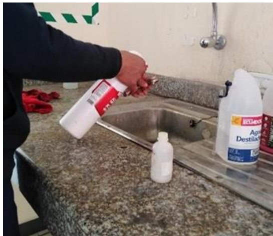
Figura 9-3: Ataque químico con Nital: Realizado por: Toapaxi Wilson: 2020
