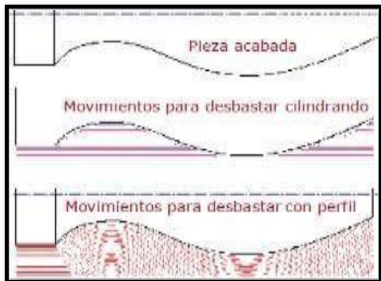
Figura 7-2: Desbastados en control numérico Fuente: (Tornero, 2012))
