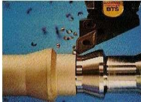
Figura 8-2: Herramientas en corte Fuente: (Tornero, 2012))
