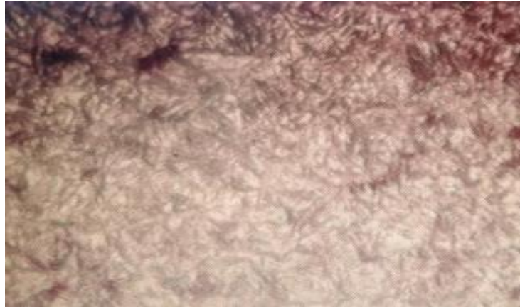
Figura 11-3: Microestructura compuesta por martensita y austenita en la biela original
