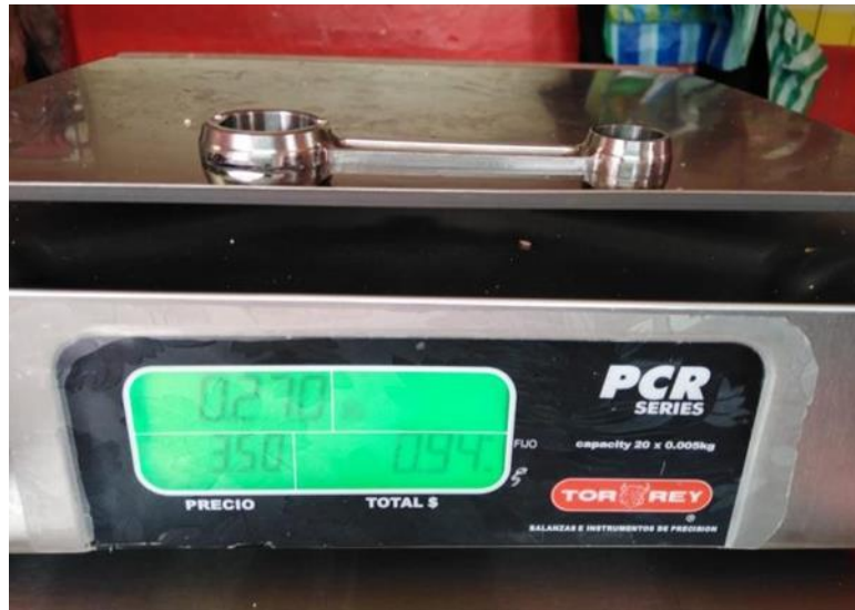
Figura 29-3: Peso del prototipo de la biela de motor de moto. Realizado por: Toapaxi Wilson: 2020
