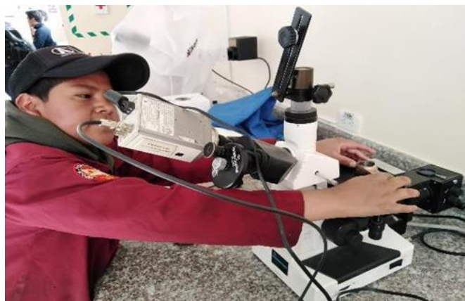
Figura 10-3: Ubicación de la biela en el microscopio viewmet buehler: Realizado por: Toapaxi Wilson: 2020
