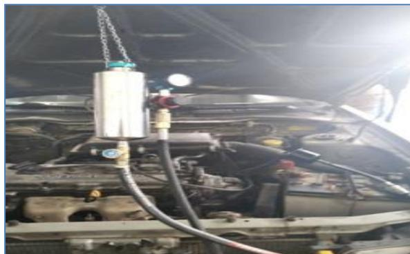
**Figura 21-2.** Colocación de canister.
