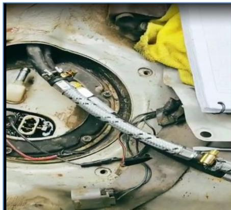
**Figura 26-2.** Desconexión de la bomba
