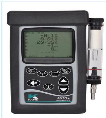
**Figura 4-2.** Analizador de gases
