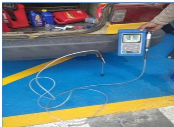
**Figura 22-2.** Colocación de la sonda en el tubo de escape.
