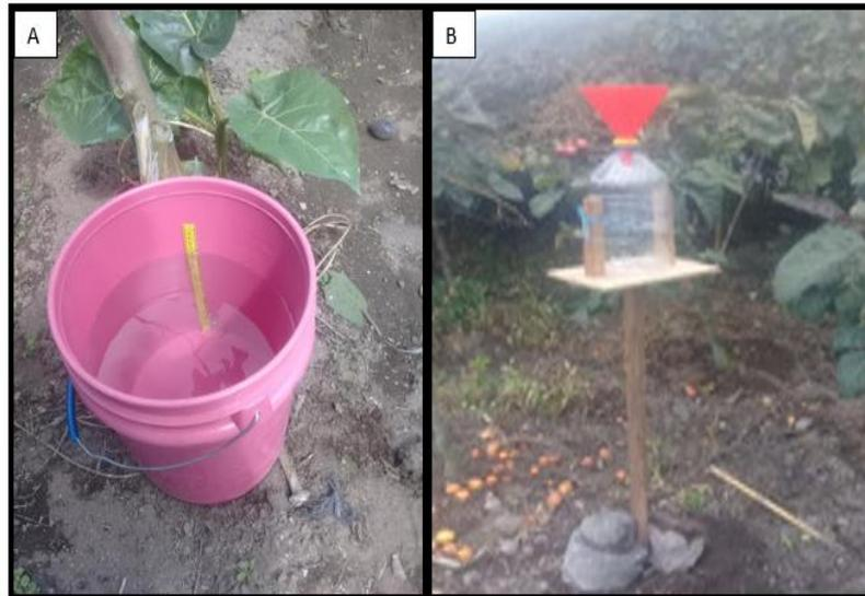
**Figura 1-2.** Implementación de pluviómetro y evaporímetro casero
