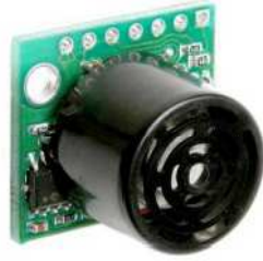
Figura III.7: Sensores de ultrasonido MaxSonar-EZ1 usados en el modulo sonar, MAXBOTIX® INC (17).
