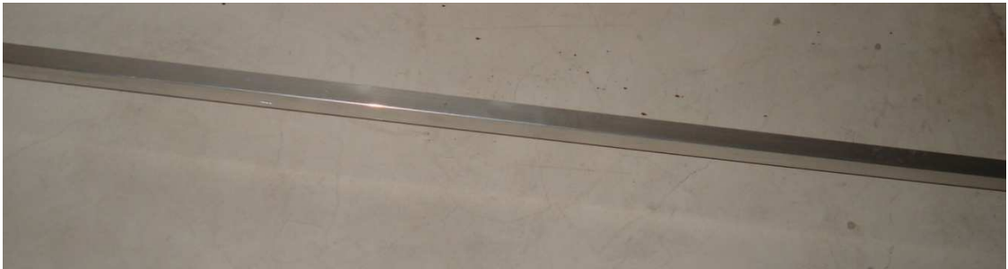
Figura II.13. Material de aluminio de 2 pulgadas para la estructura
