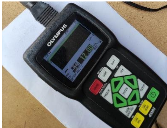
Figura 20-2: Recolección de datos de los espesores de las placas de acero ASTM A36
