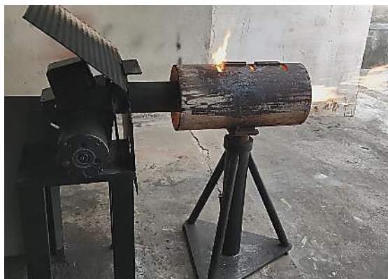
Figura 12-2: Pruebas en vacío del quemador a diésel para la experimentación
