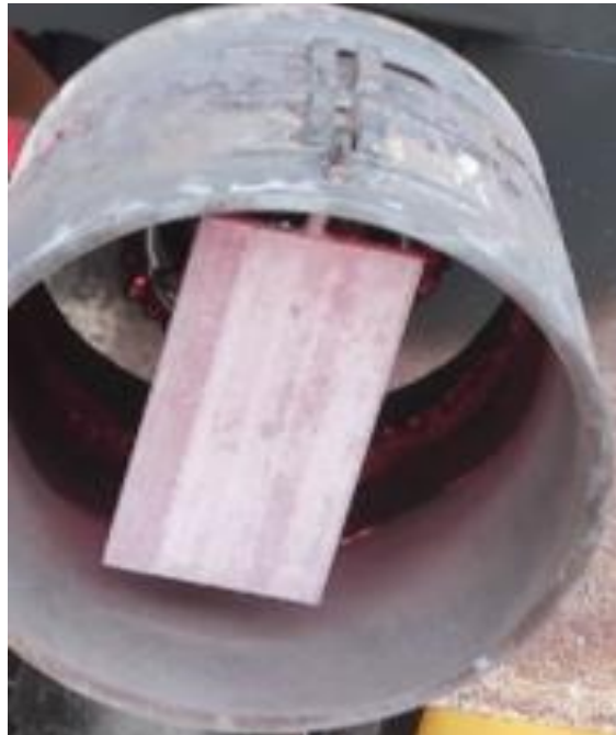
Figura 4-3: Enfriamiento a temperatura ambiente de la probeta
