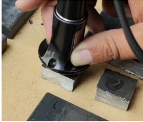
Figura 19-2: Medición del espesor de la placa de acero ASTM A36
