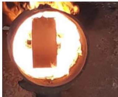
Figura 1-3: Exposición de las probetas al fuego
