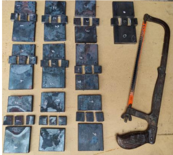
Figura 26-2: Corte de las probetas de acero ASTM A36 para ensayos de metalografía
