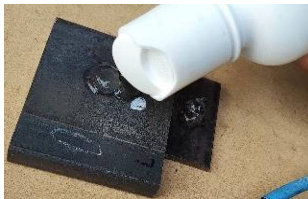
Figura 18-2: Aplicación del gel acoplante sobre la superficie del acero ASTM A36
