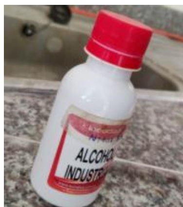
Figura 30-2: Nital al 2% para ataque químico
