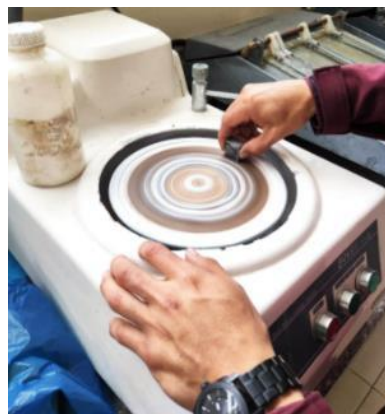
Figura 28-2: Pulido de las probetas
