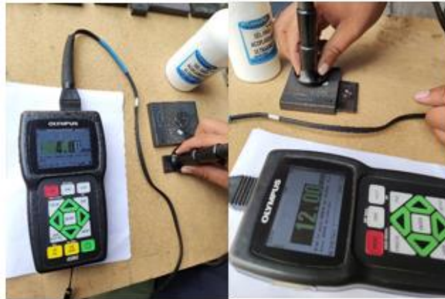
Figura 17-2: Calibración del equipo de ultrasonido Olympus MG 45
