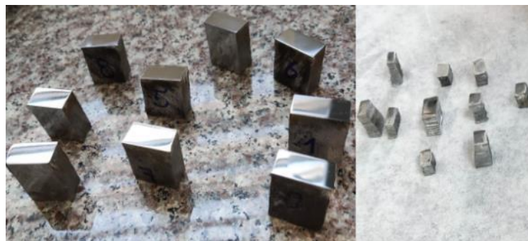
Figura 3-3: Acabado tipo espejo de las probetas para metalografía
