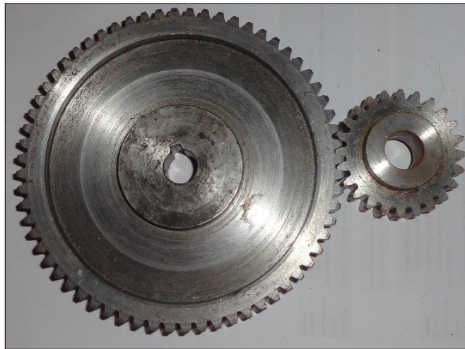
Figura 1-4: Ruedas dentadas a someter a fallas
