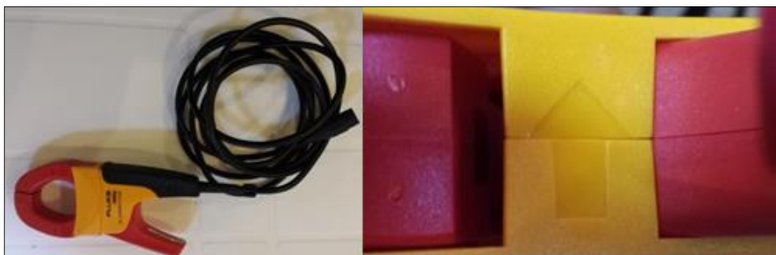
Figura 12-3: (a) Pinza amperimétrica. (b). Sentido del flujo de corriente
