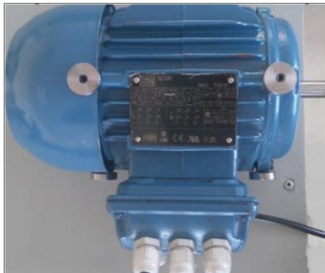
Figura 1-3: Motor eléctrico trifásico de ½ Hp
