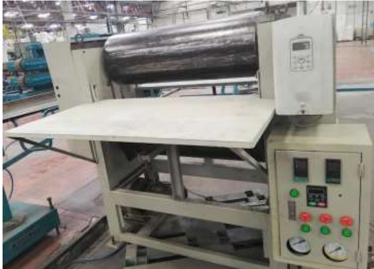
Figura 26-3: Ensamble máquina de estampado de rodillos
