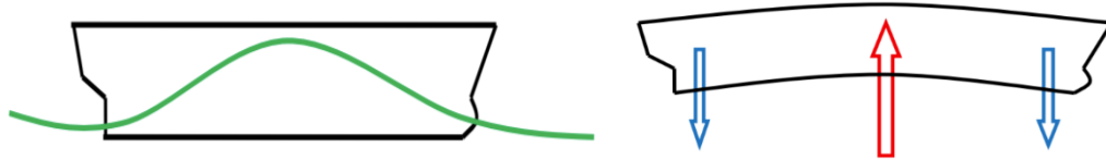
Figura 6-2: Esfuerzo de quebranto en una embarcación
