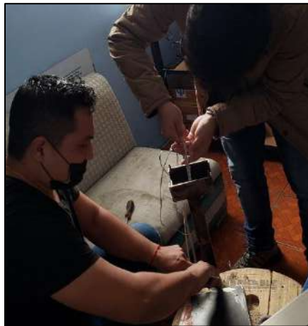
Figura 17-3: Ensamble de cables de control y resistencia a través del pedestal.
