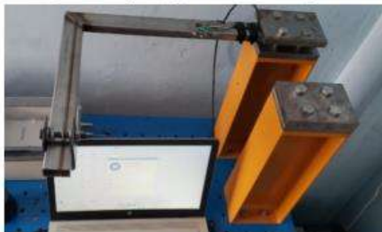
Figura 5. Ensamble de la probeta en las mordazas del banco de extensometría.
