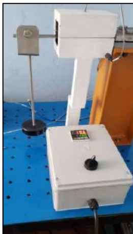
Figura 45-3: Posicionamiento de la cámara de control térmico sobre el banco de pruebas.
