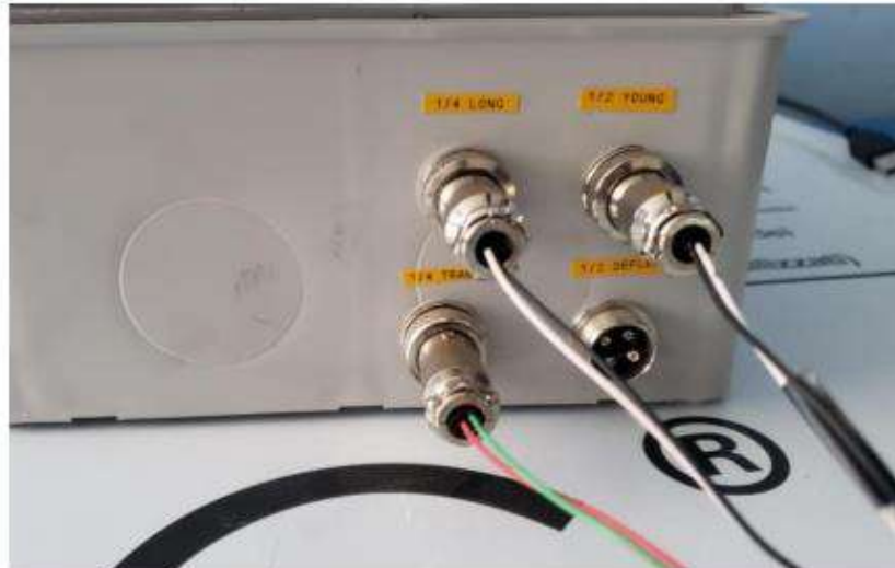
Figura 6. Conexión caja adquisidora de datos - galga tipo roseta
