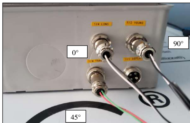
Figura 34-3: Diagrama de conexión para galga triaxial
