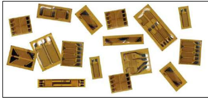
Figura 5-2: Galgas extensiométricas Omega
