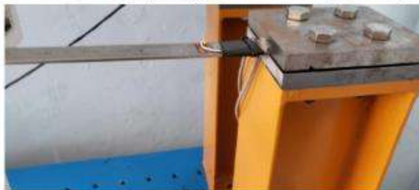
Figura 4. Ensamble de la probeta en las mordazas del banco de extensimetría.
