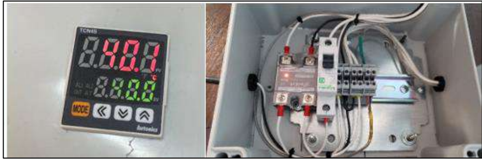
Figura 18-3: Circuito de control cámara térmica
