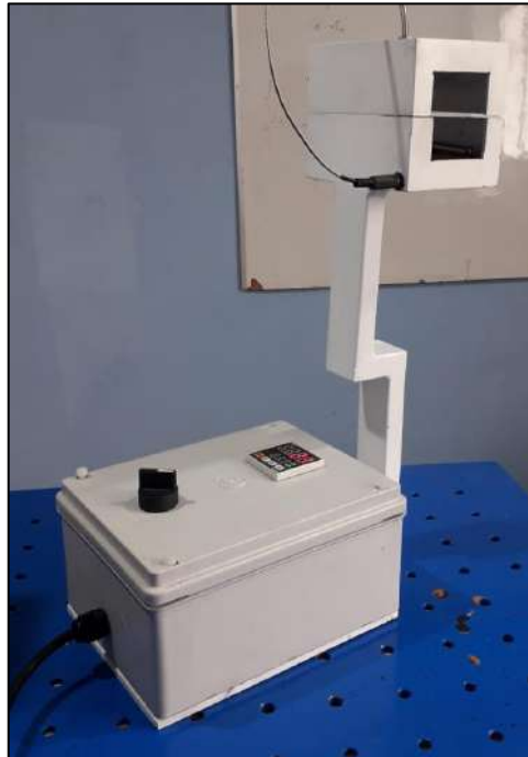
Figura 19-3: Cámara térmica construida (producto final)
