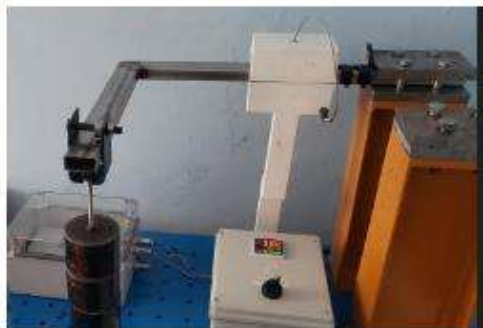
Figura 7. Posicionamiento de la CCT sobre el banco de extensimetría.
