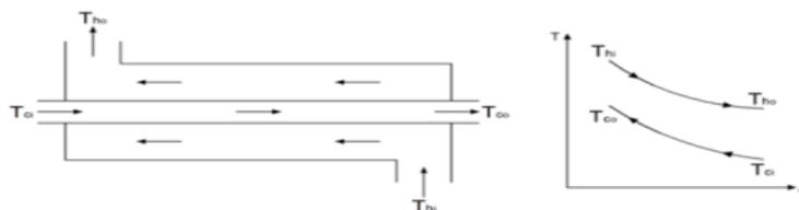
**Figura 6-2:** Traspaso calórico de contraflujo
