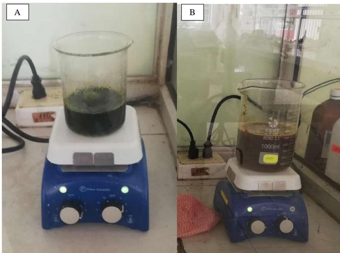
**Gráfico 3-2:** Proceso de Hidrólisis alcalina: A) Hidrólisis de hojas de maíz, B) Hidrólisis de tallo de maíz.
