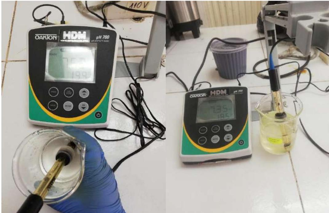
**Gráfico 6-2:** pH del agua de lavado de la hidrólisis alcalina
