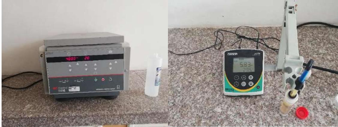
**Gráfico 9-2:** Centrifugación y Medición del pH
