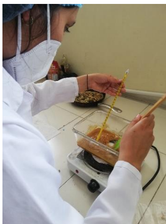
Figura 15-3. Control de temperatura del aglutinante.
