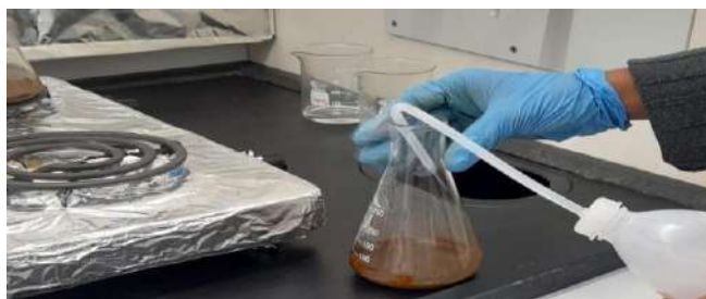
Figura 48-2: Colocación de H 2 O 2 en el proceso de digestión
