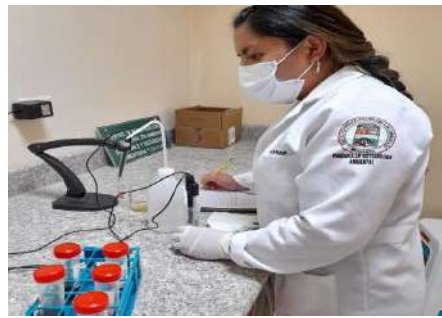
Figura 40-2: Medición de la CE
