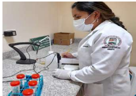
Figura 20-2: Medición de la CE
