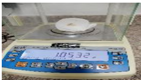
Figura 14-3. Determinación de Biomasa por peso seco
