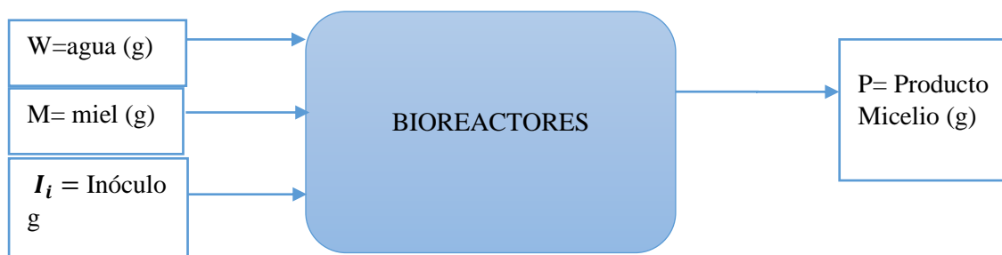
Figura 18-3. Transferencias de masa de los biorreactores
