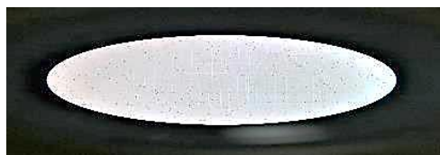
Figura 12-3. Determinación del número de conidios en cámara de Neubauer.
