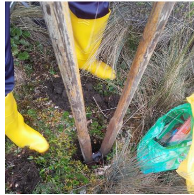
C2. Recolección de muestras para análisis físico-químico profundidad 0-30 y 30-60cm.
