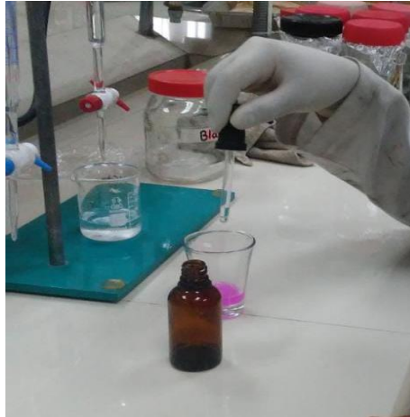
Figura 11-2. Adición de fenolftaleína a la solución
