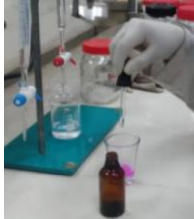
E14. Solución concentrada agregada 4 ml de BaCl 2 y 2 gotas de fenolftaleína.
