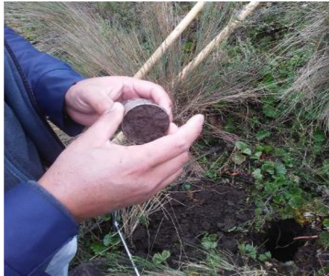
C3. Utilización de cilindros en la zona para analizar densidad aparente y humedad.
