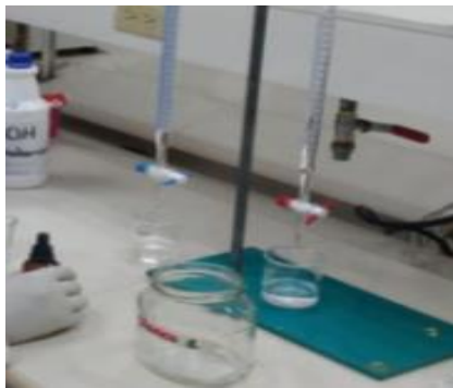
E15. Titulación de las muestras. Utilizando como titulante al HCl.
