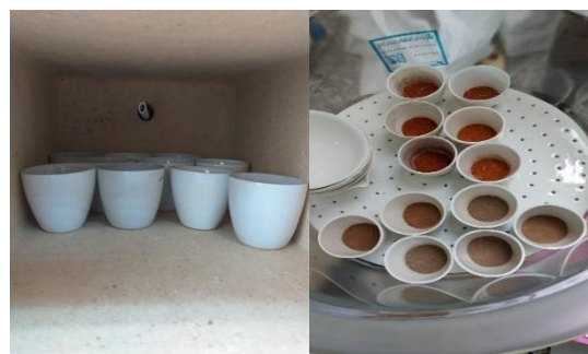
Figura 24.3. Crisoles etapa inicial y final para determinar porcentaje de materia orgánica.
