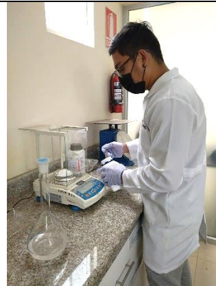
Figura 28.3. Preparación de soluciones madre para estándares de P y K.
