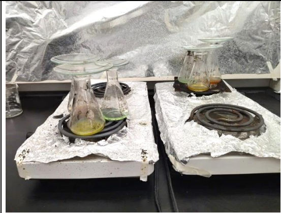
Figura 26.3. Digestiones ácidas de muestras vegetales con ácido sulfúrico.
