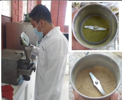
Figura 18.3. Molienda y triturado de biomasa vegetal.
