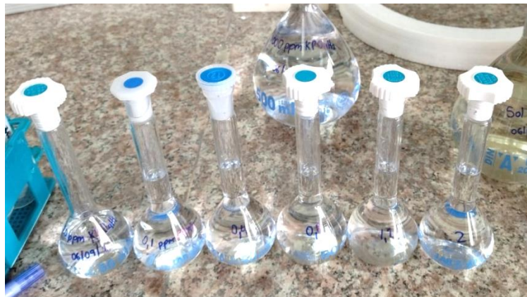
Figura 14-2. Estándares para curva de calibración de fósforo.
