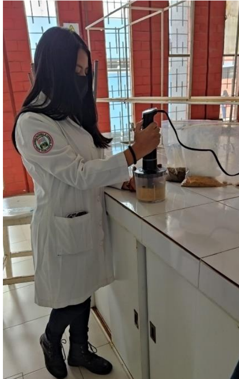
Figura 4-2. Trituración de muestras deshidratadas
