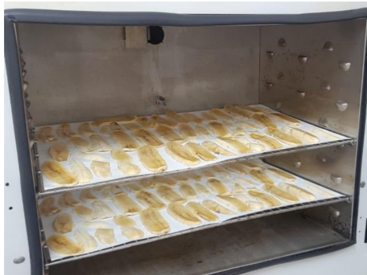
Figura 3-2. Secado de muestra mediante evaporación superficial
